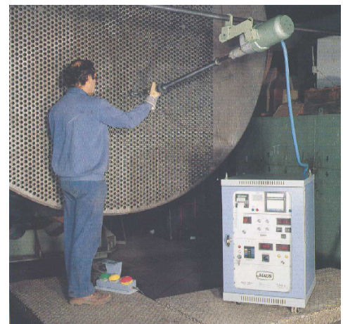
Invalsning av tuber med utrustning med momentkontroll, ytterligare ett exempel.
