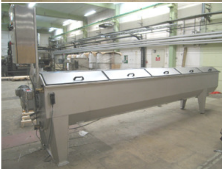
1 st. Trumförtjockare Slasken SF35, färdig för leverans till ett reningsverk i Lettland
