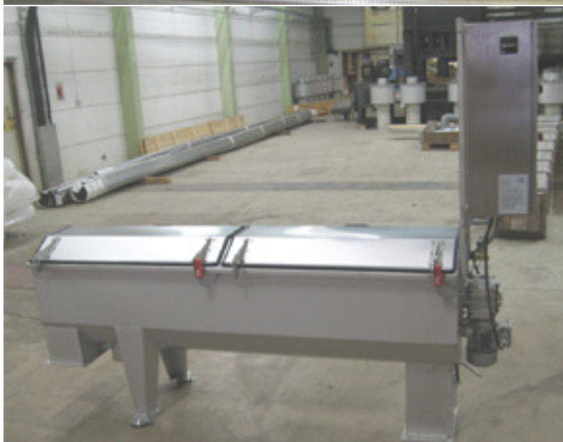
En Slasken SF7 inklusive styrskåp, färdig för leverans till ett reningsverk i Rumänien.
