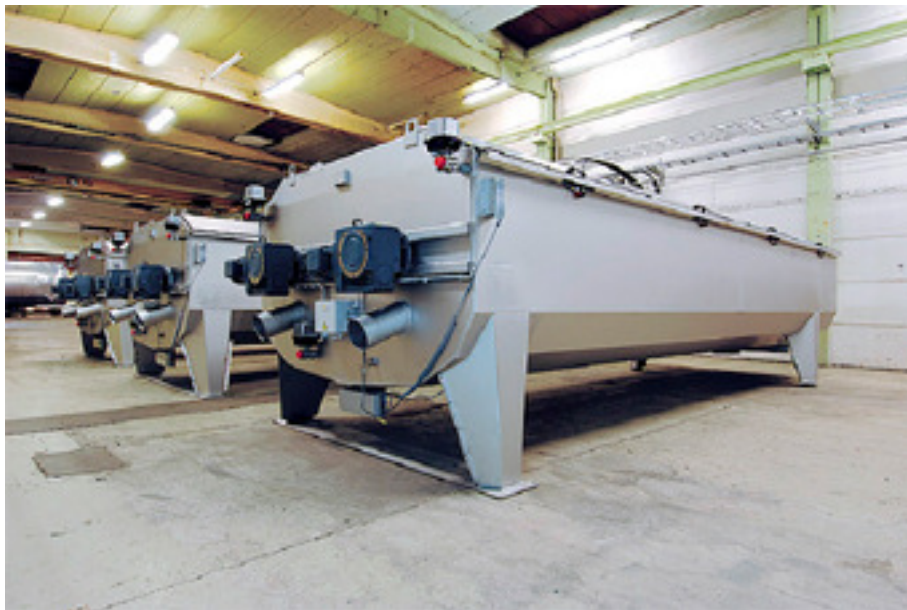
3 st trumförtjockare Slasken SF 120 färdigställda för leverans till ett reningsverk i Liuzhou, Longquanshan, Kina
