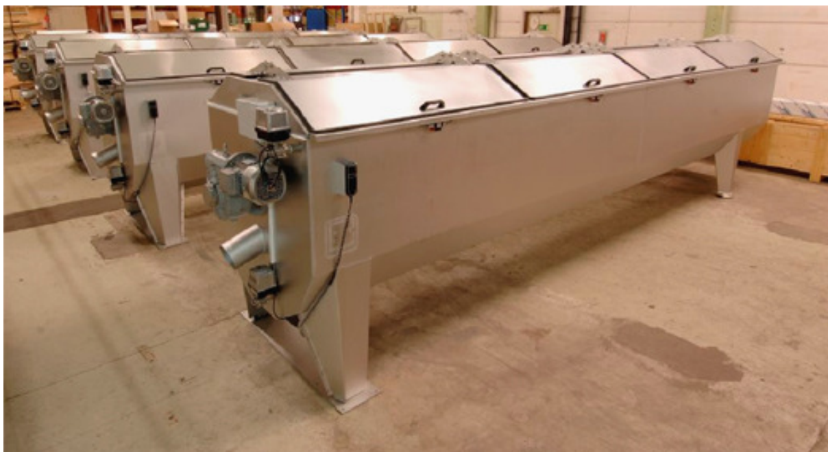
4 st trumförtjockare Slasken SF 60, färdigställda för leverans till ett reningsverk i Changsha, Kina
