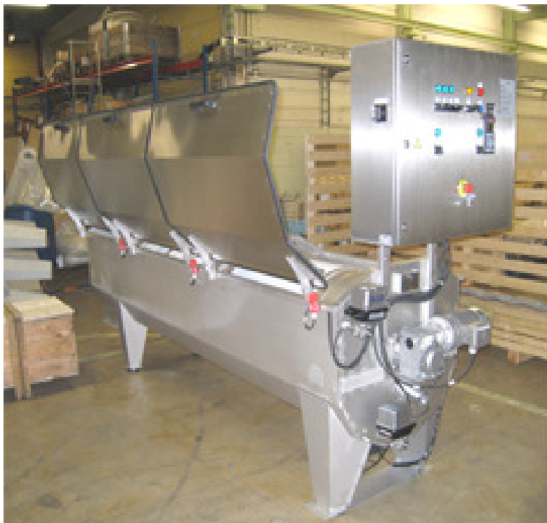
En trumförtjockare Slasken SF17, färdig för leverans till ett reningsverk på Öland
