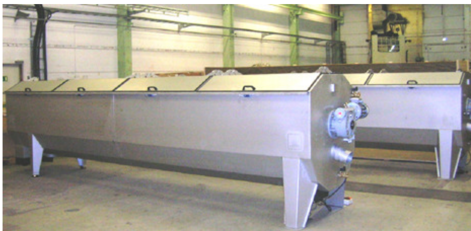
2 st trumförtjockare Slasken SF 60 färdigställda för leverans till ett reningsverk i Litauen.
